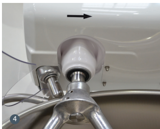
4 Relevage électrique du bras / Electrical lifting of mixing arm
