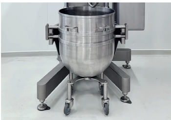
3 Edelstahlkessel auf Rollen
