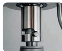
Système d'attache rapide de l'outil (version snacking)
